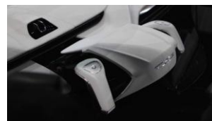
크라이슬러 Portal 컨셉 조이스틱 형태의 스티어링휠 수납 가능(retractable)
