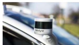
포드 자율주행 시험차 차량 주변 레이저 센싱 가능한 LIDAR 장착
