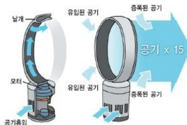
<그림3> Dyson社 Air Multiplier의 구동원리
